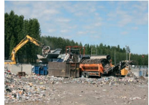
Jäteperäisen polttoaineen valmistus sekajätteistä murskaamalla ja seulomalla.
